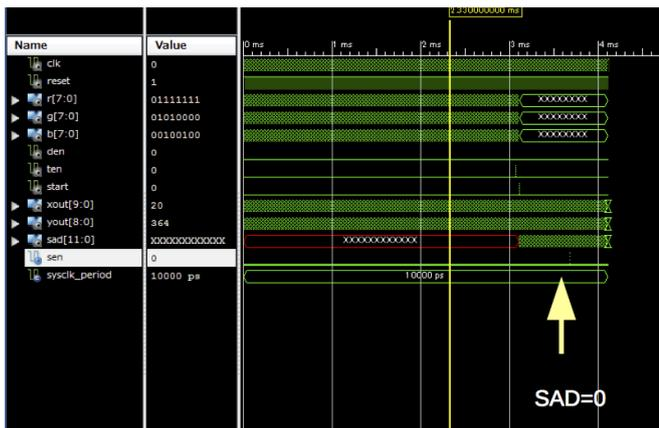
図 6b. 画像マッチングポイントを発見したときの波形
